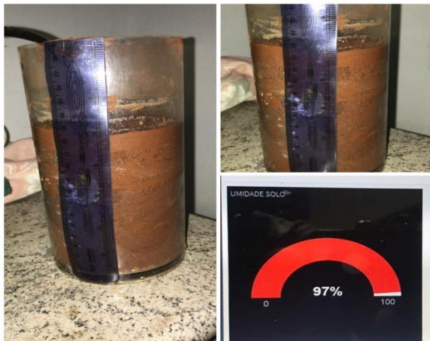
Figura 25: Medição da umidade do solo em terra saturada com 12 cm de altura no tubo de acrílico de 2 litros.
